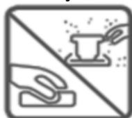
Após o processo de reparação, prepare a superfície efetuando o lixamento com lixa grão 400 e/ou 600. Limpe o local do reparo com Solução Desengraxante Maxi Rubber, eliminando contaminantes oleosos, pó e outras impurezas que possam comprometer o produto.
