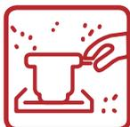
Lixar com lixa 80 ou lixa 150. Em seguida limpar a peça com Solução Desengraxante Maxi Rubber.
