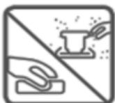
Deve-se lavar a peça com água e sabão neutro até retirar todas as impurezas, óleos e possíveis silicones. Secar e passar a Solução Desengraxante por toda a superfície. Lixar a peça com uma lixa grão 400, se o substrato for texturizado, e com lixa grana 600, se este for liso. Desengraxar novamente toda a superfície.
